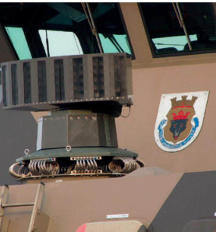
Täuschkörperstarter der Firma Rheinmetall auf dem finnischen Kriegsschiff Pori
